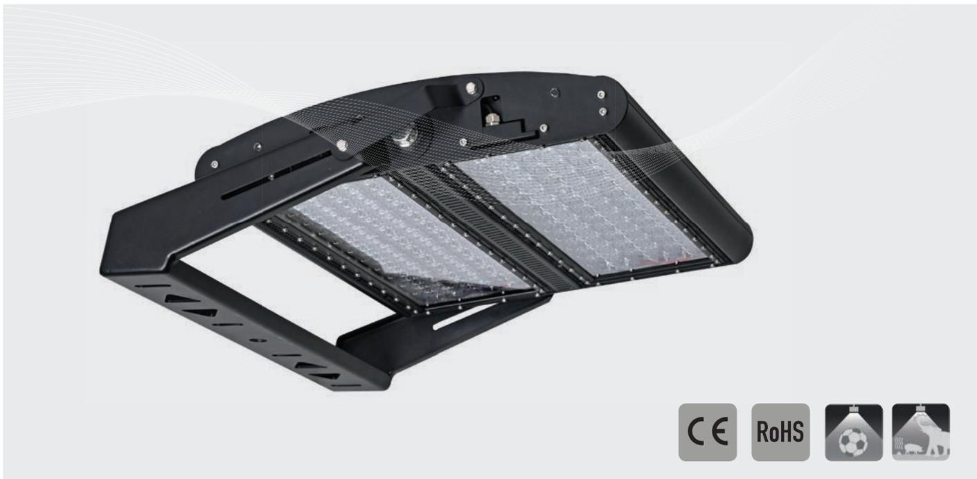
APOLLO - , staffa di montaggio rinforzata in, scatola in pressofusione di alluminio con alette di raffreddamento, nero (RAL 9011) verniciatura a polvere - stabilizzato UV, copertura in vetro temprato (IK8), ottica lenticolare in policarbonato, Lumileds / LUXEON 5050, programmable, dimmable control gear
